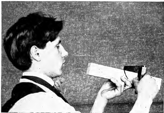
Fig. 41—Testing First Edge
